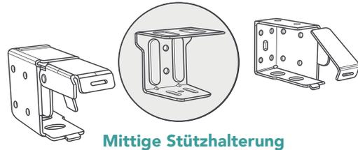
Öffnen Sie die Klappen der Boxenhalterungen, schieben Sie die Oberschiene in die richtige Position und lassen Sie anschließend die Klappe einrasten.
