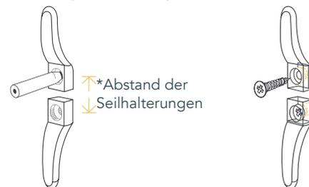
Markieren Sie die Position der Bohrlöcher und bohren Sie diese nach Bedarf.
